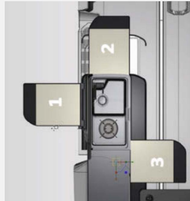
Der variable Außenklapptisch kann nach Bedarf an Position 1, 2 oder 3 verwendet werden.
